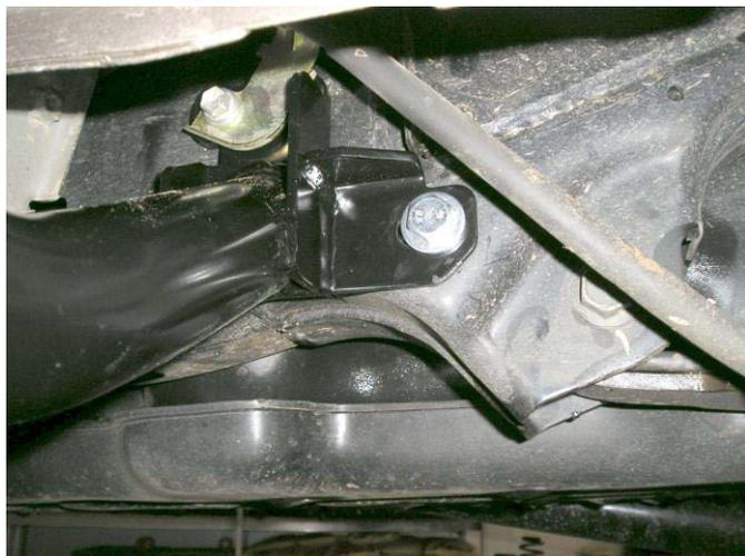
7. Наживите заднее крепление к шасси болтами М10х35, вставленными снаружи, используя шайбы М10 и фланцевые гайки М10.
