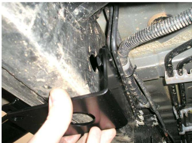
9. Присоедините центральный бреклет к шасси изнутри рамы и присоедините центральное крепление. Закладную гайку расположите в отверстии рамы.
