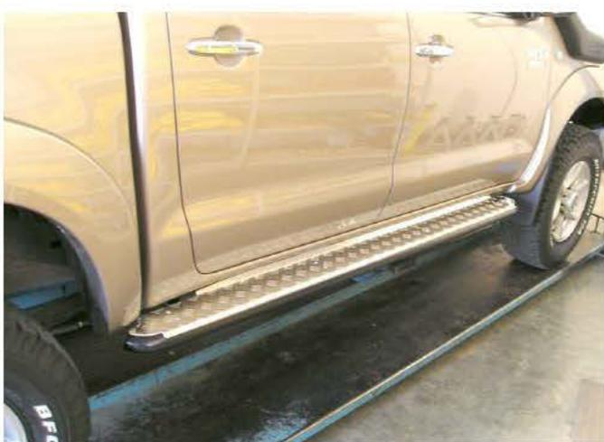
21. Пролейте силиконовым герметиком ту часть подножки, которой будет касаться плита. Это уберет вибрацию при эксплуатации.
