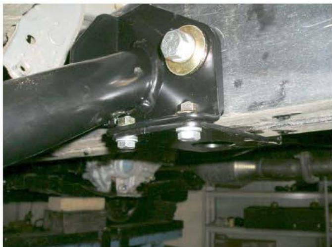
11. Используя два болта М8х20, шайбы М8 и фланцевые гайки М8 соедините брекет с центральным упором.
