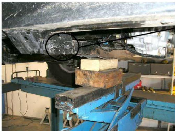
3. Работая с каждой стороны отдельно, поддомкратте поперечину КПП и выкрутите два внешних болта. Они вам больше не понадобятся.
